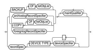
(listObjList::=, archivelogRecordSpecifier::=, foreignlogRecordSpecifier::=, maintQualifier::=, recordSpec::=, deviceSpecifier::=)
